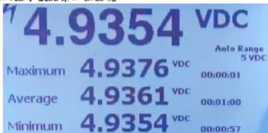
圖 2、SA VCC 腳位量測電壓數據圖
