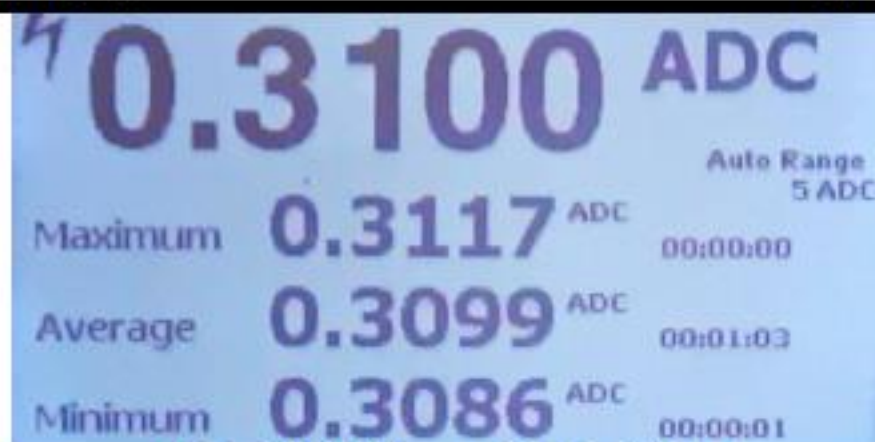
圖 3、SA VCC 腳位量測電流數據圖
